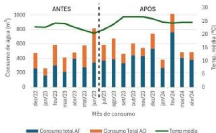
Figura 7: Consumo total mensal de água quente no edifício ( m^3 ) comparado com a temperatura ( ^{\circ}C ).
